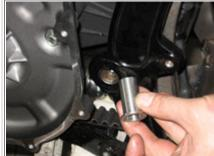
"Schmale" Distanzhülse von außen in den Rahmen durch die Buchse und das Schwingenlager führen.
