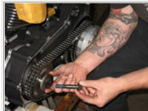
Primärantrieb einsetzen. Sprocketshaftschraube einsetzen.
