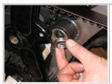
Mitgelieferte Zwischenbuchse links einsetzen.
