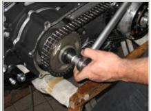
Sprocketshaftschraube mit Drehmoment anziehen.
