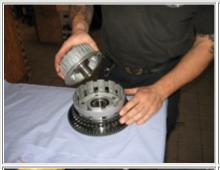
Original Kupplungsnabe auspressen. Mitgelieferte Kupplungsnabe einpressen. Kupplung zusammen bauen. (Siehe Service Manual)
