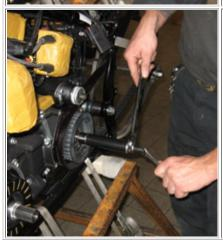
Primärstützlagering auf der Hauptwelle aufsetzten.
